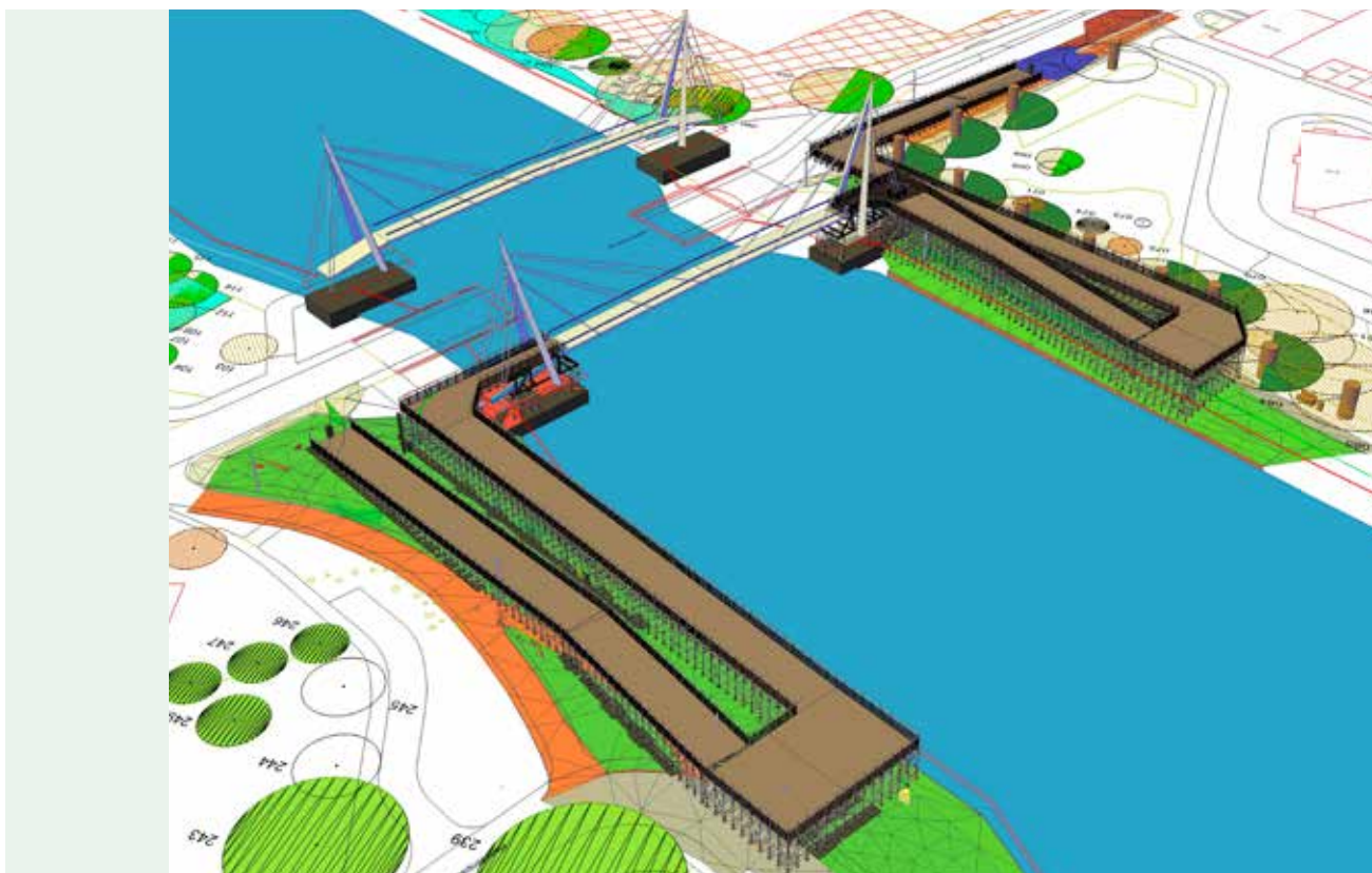
De hellingbanen bestaan uit een steigerconstructie. Er kan op gefietst worden en de route is makkelijker te passeren voor bijvoorbeeld mensen met een rolstoel of scootmobiel. Tekening: Rijkswaterstaat.
