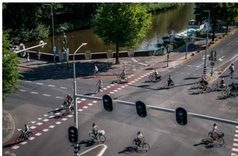
Terwijl de auto's en de bussen stil staan, kunnen de fietsers vanuit alle richtingen het kruispunt Stationsweg-Hereweg oversteken. Foto: Siese Veenstra.
